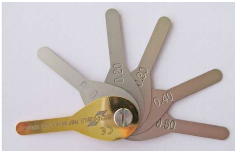
Abbildung 7. Das CA® Messlehen-Set besteht aus 5 Messlehen verschiedener Stärken (0,10 mm, 0,20 mm, 0,30 mm, 0,40 mm und 0,5 mm), die in die Interdentalräume eingebracht werden können, um den Schmelzabtrag zwischen den Zähnen vor und nach dem Strippen zu messen. Durch Kombination der Messlehen kann ein Abtrag zwischen 0,10 mm und 1,5 mm erfasst werden.
