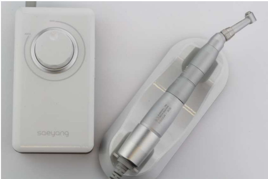
Abbildung 1. Zum Strippen werden ein Handstück Typ SMT MARATHON K-33 und ein abgewinkeltes EVA- Winkelstück Typ NAKAMURA DENTAL MfG Co. Ltd. verwendet.
